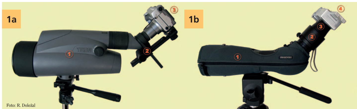
Obr. 1a, 1b: Dvě ukázky fungujících sestav pro digiscoping
