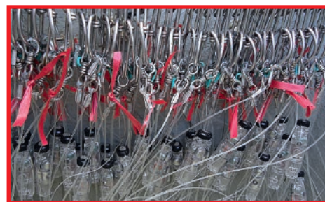
Hák obsahuje kryt, chrání hrot i zpětný háček, který se pomocí pružiny uvolňuje až v dostatečné, předem zvolené hloubce.
