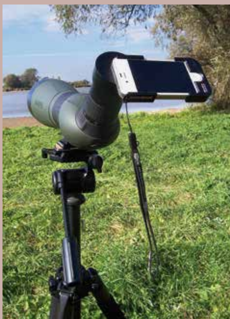
Jednoduchý postup nasazení telefonu do nástavce Meopix a na stativový dalekohled.
