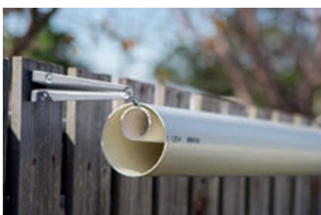
Rotující systém „udělej si sám“ – širší polykarbonátová trubice se otáčí u uší trubici (návod na purrfectfence.com )
